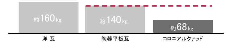
■屋根材別「重さ」比較 (1坪当りの重さ)
